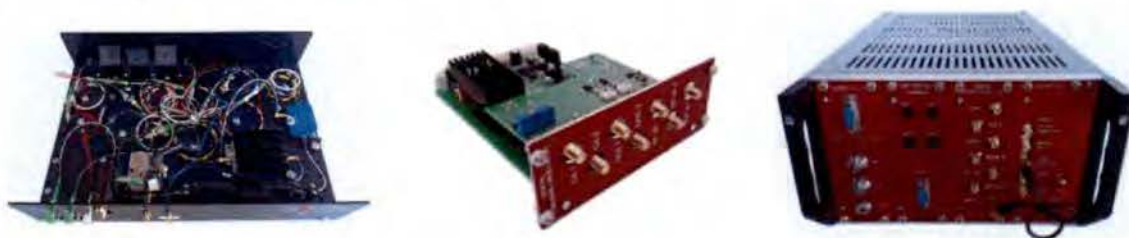
Obr. 4: Sestava detekčního vláknového laserového interferometru. Vlevo: Pohled na experimentální optické uspořádání, které umožňuje konfiguraci interferometru Michelson i Mach-Zehnder. Kromě vláknové optiky obsahuje deska 1530nm polovodičový laser, AOM driver a fotodetektor. Uprostřed: Karta pro interferometrickou fázovou demodulaci a digitální zpracování signálu. Vpravo: Šasi obsahující veškerou elektroniku, včetně referenčního RF oscilátoru a zdroje laseru.
