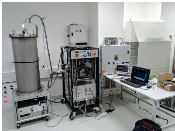
Obr. 22: Vlastnosti 100 kV zdroje bylo třeba stanovit pomocí dlouhodobých testů a měření, ke kterým si ÚPT vyvinulo i vlastní měřicí zařízení, např. precizní referenční vysokonapěťový dělič. Na snímku je sestava obou zařízení během měření dlouhodobé stability zdroje.
